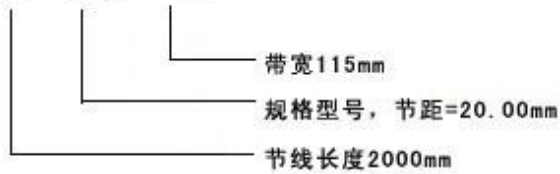
20M 圆弧齿同步带规格、型号、尺寸(节距=20.00mm)
