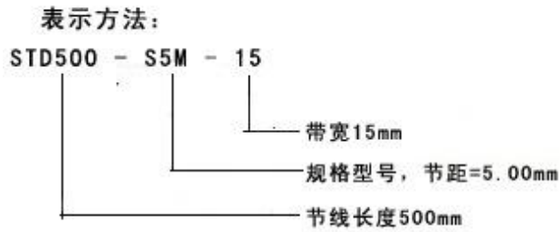
S5M 圆弧齿同步带规格、型号、尺寸(节距=5.00mm)
