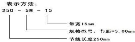
5M 圆弧齿同步带规格、型号、尺寸(节距=5.00mm)
