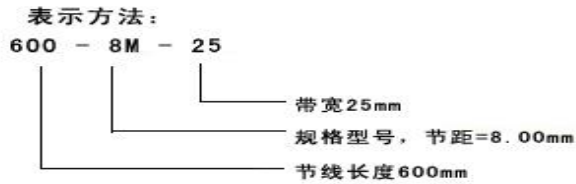
8M 圆弧齿同步带规格、型号、尺寸(节距=8.00mm)
